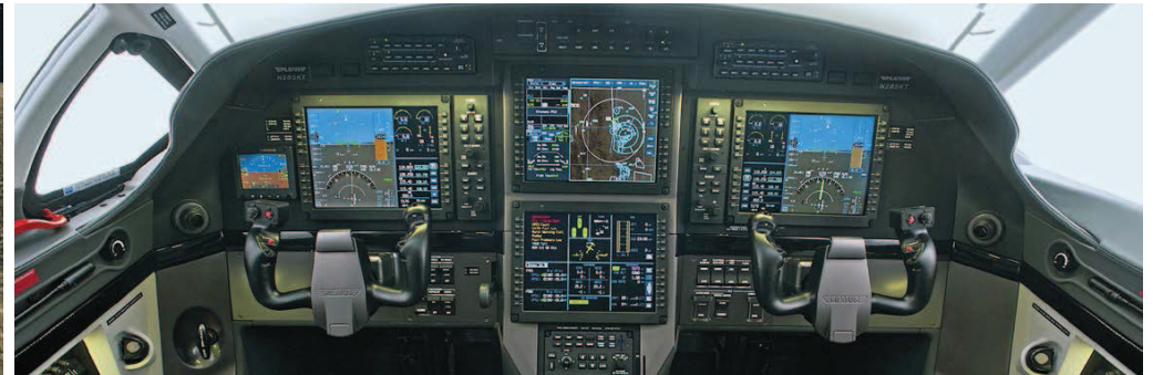
Visionär: 2006 modernisiert Pilatus die PC-12 zur „Next Generation“ und stattet sie mit einem Primus-Apex-Avioniksystem von Honeywell aus. Das Synthetic Vision System SmartView hilft den Piloten durch die Darstellung von Gelände- und Wetterinformationen bei der Orientierung.
