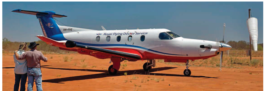
Durchdacht: Viel Bodenfreiheit hatte der Propeller schon bei früheren Modellen. Ab 2016 wurde bei der PC-12 NG ein Fünfblatt-Composite-Propeller von Hartzell verbaut, der aufgrund dünnerer Blätter einen geringeren Luftwiderstand erzeugt und zu einer besseren Leistung führt.
