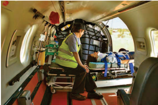
Universell: Die 9,34 Kubikmeter große Druckkabine lässt sich individuell anpassen, daher eignet sich die PC-12 gut als Ambulanzflugzeug.
