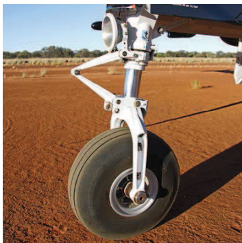
Strapazierfähig: Auch härtere Landestöße können dem massiven Bugrad nichts anhaben.
