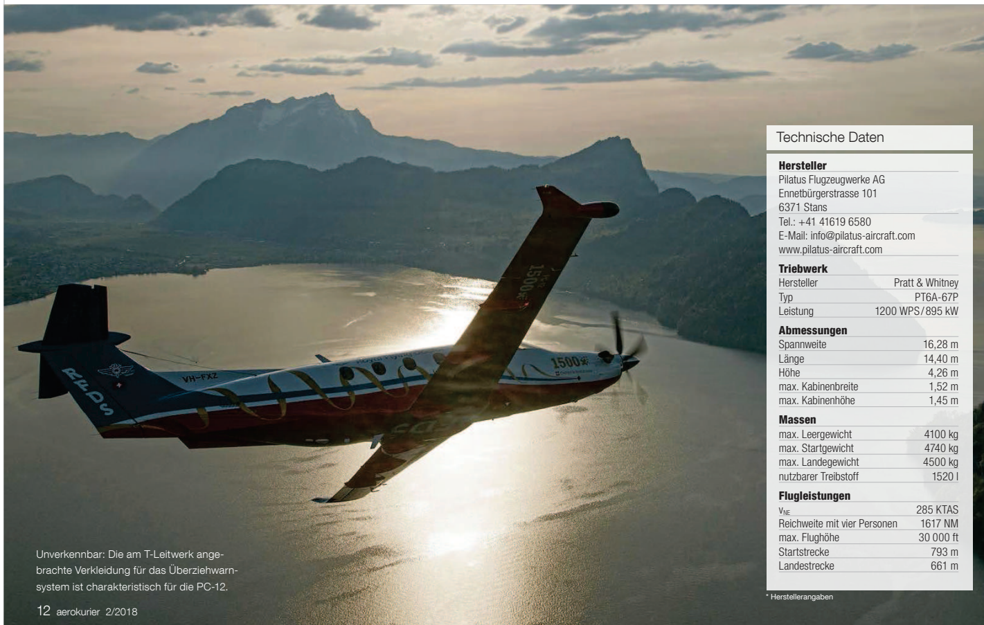
Universell: Die 9,34 Kubikmeter große Druckkabine lässt sich individuell anpassen, daher eignet sich die PC-12 gut als Ambulanzflugzeug.
