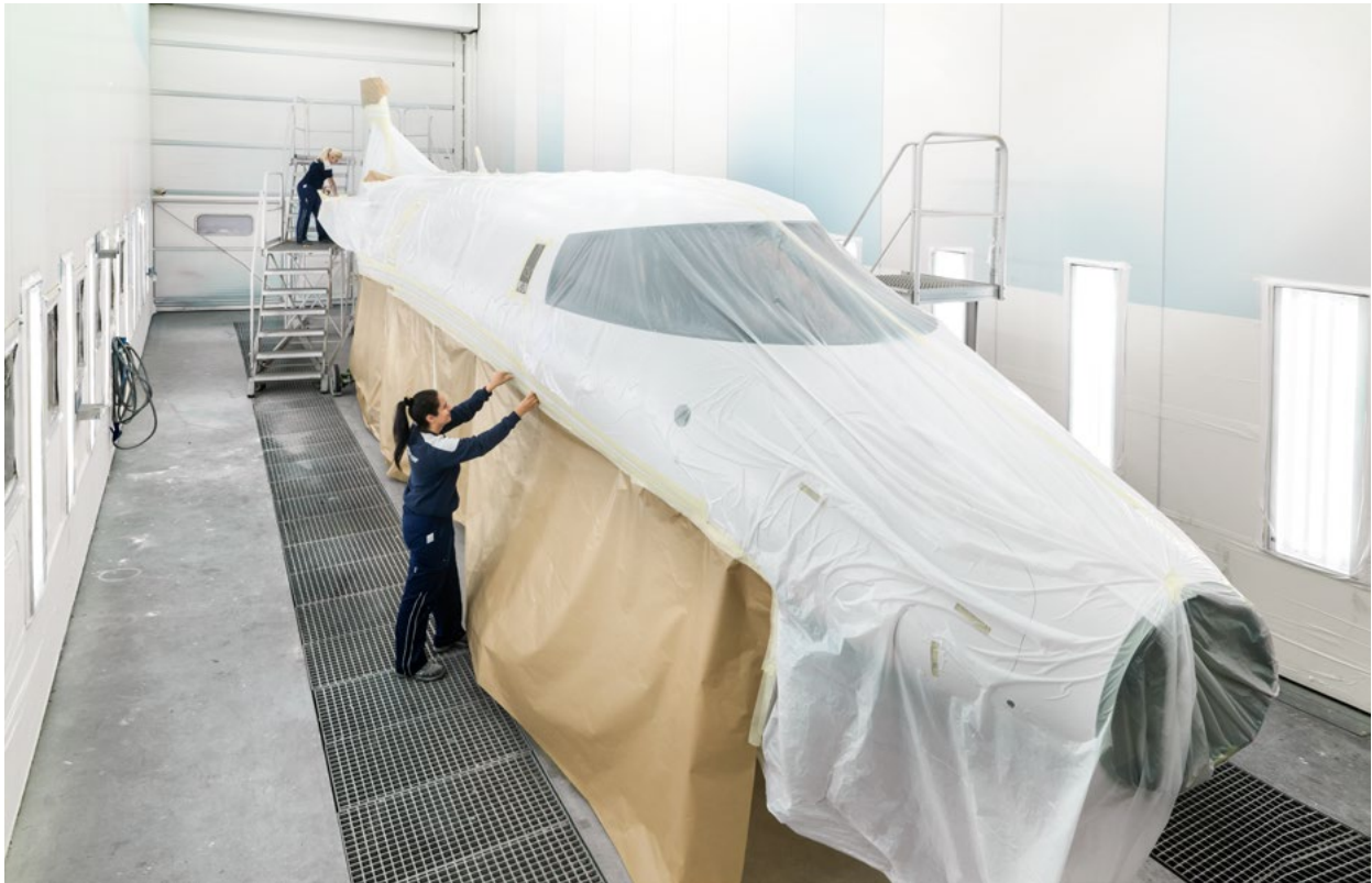
Endbemalung des PC-24 im Lackierwerk in Stans
